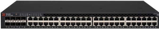
Abbildung 2: Brocade ICX 6610-Switches unterstützen acht Dual-Mode-1-GbE/10-GbE-SFP/SFP+-Ports (links) und bis zu 48 1-GbE-RJ-45- oder 24 1-GbE-SFP-Ports (rechts).
